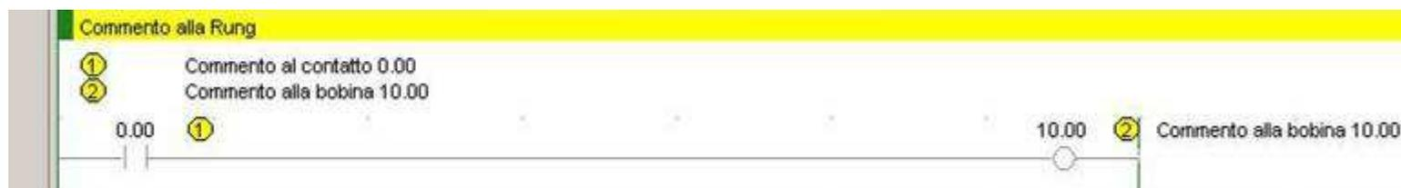
Per commentare un elemento del ladder, è sufficiente selezionarlo con il tasto destro e scegliere l'opzione "Proprietà". Lo stesso meccanismo si applica anche ai Rung.
